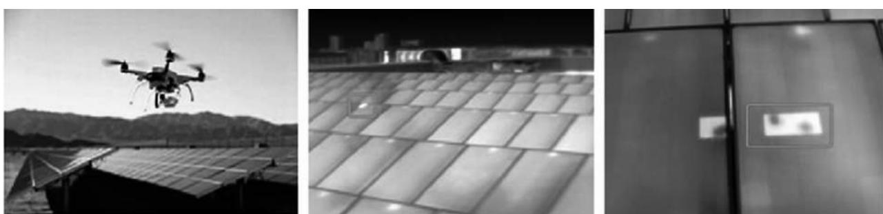
图 1 无人机搭载红外热成像装备对光伏电站的检测
